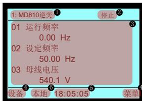
图 4-3 外引 LCD 键盘主界面示意图
