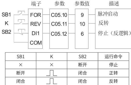
在需要运行时，必须先闭合 DI1 端子，由端子 FOR 上的脉冲产生电机运行信号，端子 REV 的状态控制电机运转方向。停车则通过断开 DI1 端子实现。
