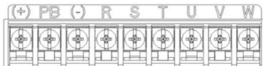
图 3-6 三相 220V 1.5kW (含) 以上主回路端子示意图
