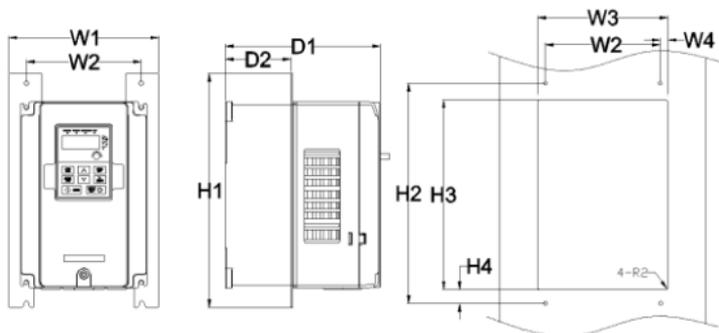
三相 380V 4~75kW 法兰安装示意图
