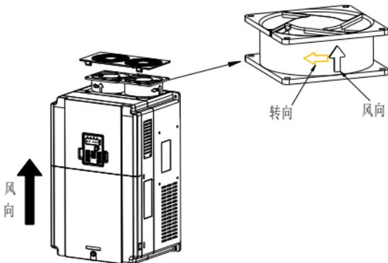
三相 380V 4kW（含）以上机器风扇维护示意图
