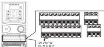
图 3-11 U 型短接位置示意图
