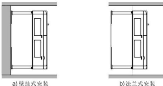
图 3-2 安装方式
