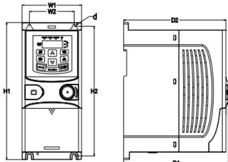
单相 220V/三相 380V 2.2kW(含)以下壁挂安装示意图
