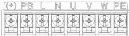
图 3-4 单相主回路端子示意图
