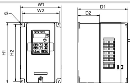
三相 380V 4~37kW 壁挂安装示意图
