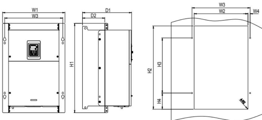
三相 380V 90~110 kW 法兰安装示意图
