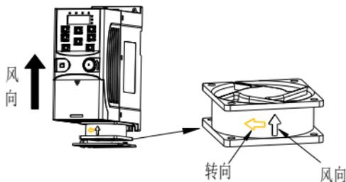
单相 220V 2.2kW（含）以下机器风扇维护示意图
