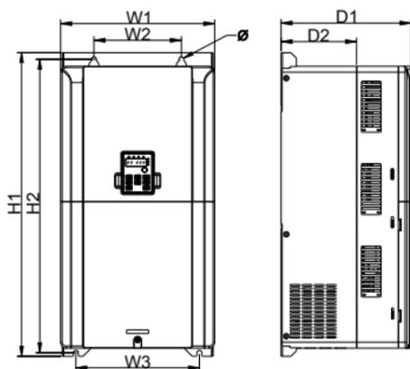
三相 380V 45~75kW 壁挂安装示意图
