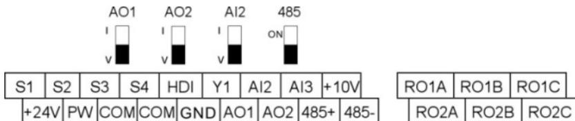
图 3-10 控制回路端子示意图
