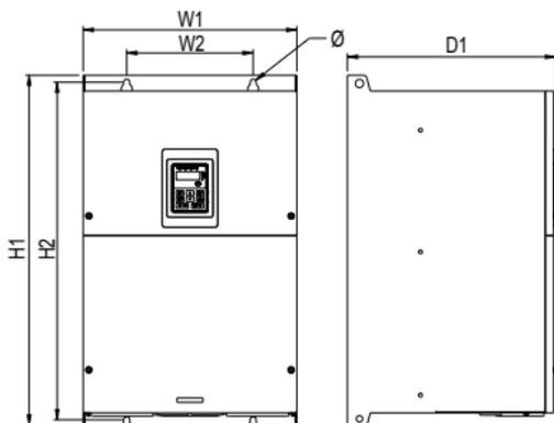
三相 380V 90~110kW 壁挂安装示意图
