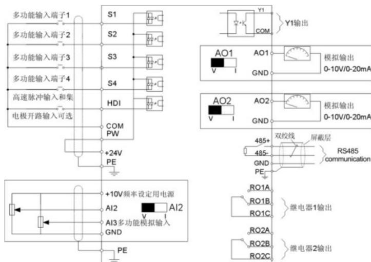
图 3-9 控制回路接线图
