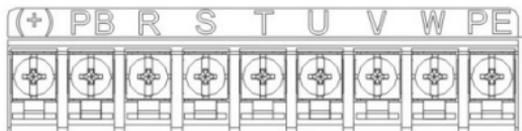
图 3-5 三相 220V 0.75kW (含) 以下主回路端子示意图
