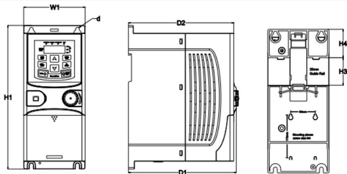
单相 220V/三相 380V 2.2kW(含)以下导轨安装示意图
