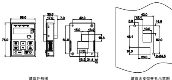
**注意：**单相 220V/三相 380V 2.2kW(含)以下、三相 220V 0.75 kW (含)以下机型选配外引键盘；三相 380V 4kW (含) 以上、三相 220V 1.5 kW (含)以上机型的键盘可用作外引。
