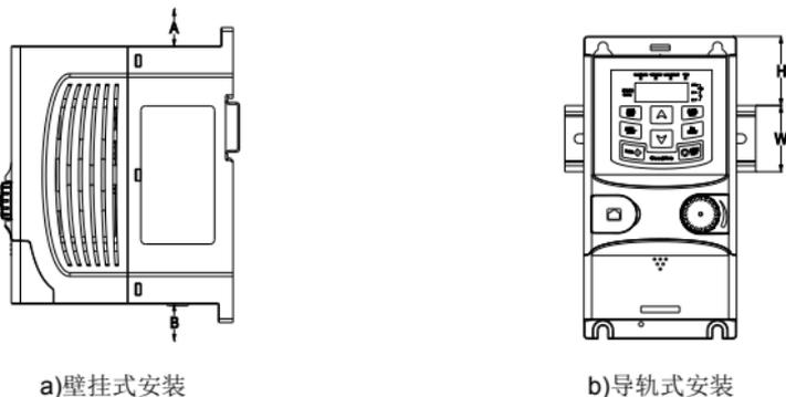
图 3-1 安装方式
