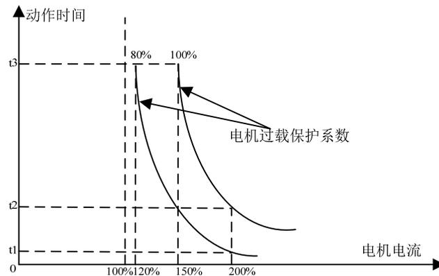
图 6-30 电机过载保护曲线示意图
