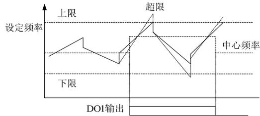
图 6-15 摆频运行上下限限制示意图
