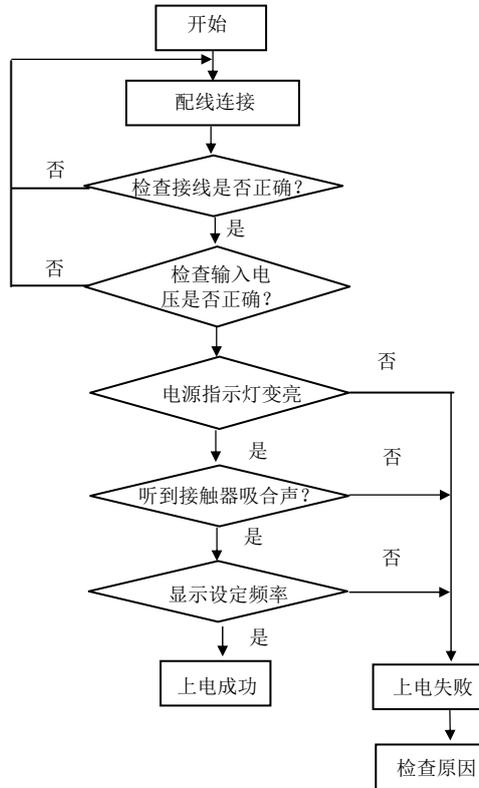
图 4-4 变频器初次上电操作流程
