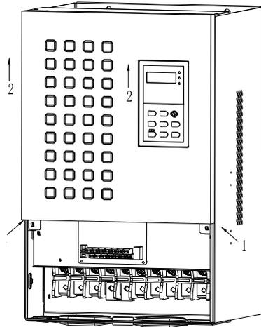
图 3-9 盖板的拆卸
