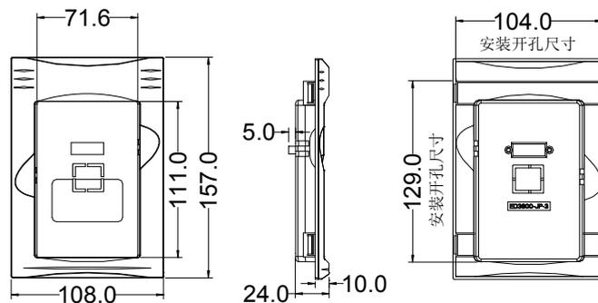
图 2-3 CV3100-RKB 托板尺寸 (RKB 键盘选配件)
