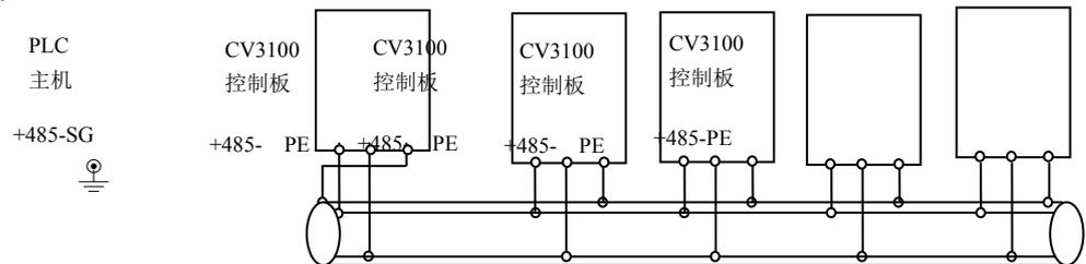
图 3-25 PLC 与变频器多机通信时的接线图(变频器、电机全部良好接地)
