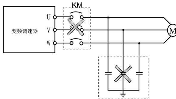
图 1-3 变频器输出端禁止使用电容器
