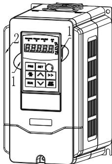
图 3-3 操作面板的拆卸
