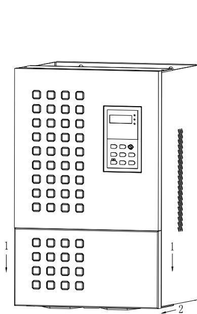
图 3-7 盖板的拆卸
