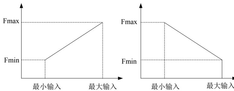
图 6-19 最大、最小模拟输入对应设定频率
