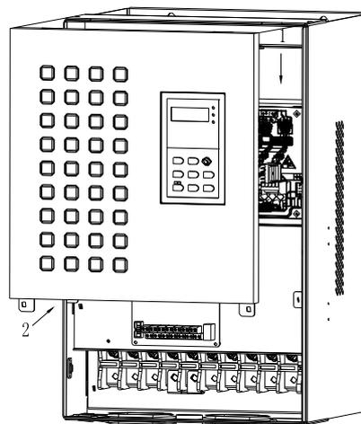
图 3-10 盖板的安装
