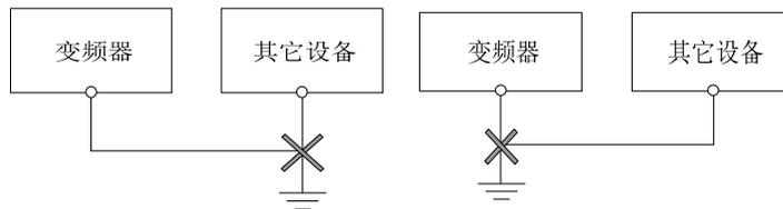
图 3-15 共用接地极示意图 (a)
