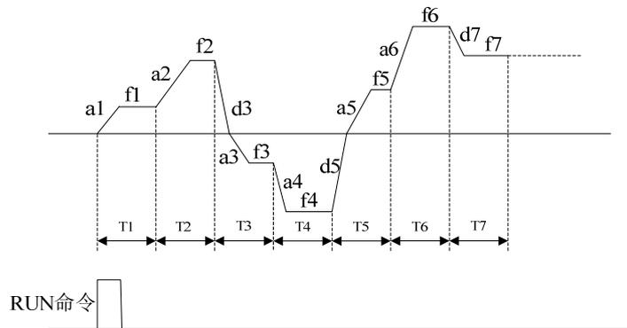
图 6-28 单循环后保持最终值示意图
