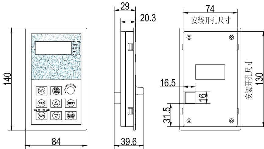
图 2-2 CV3100-RKD 键盘尺寸规格
