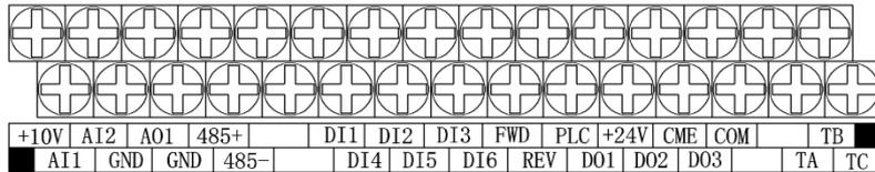
图 3-19 控制板端子排列顺序图(0.7~7.5KW 控制板)
