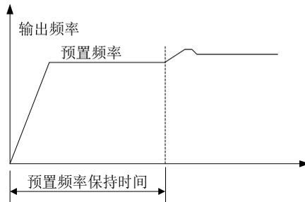
图 6-24 闭环预置频率运行示意图
