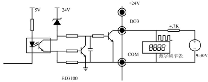
D03 端口使用变频器外部电源的外部接线示意图
