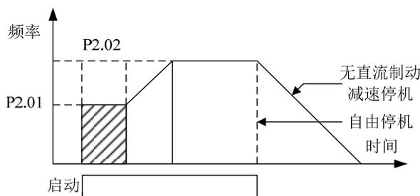
图 6-6 起动与停机频率输出曲线
