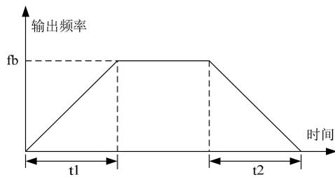
图 6-3 加速时间和减速时间设置说明
