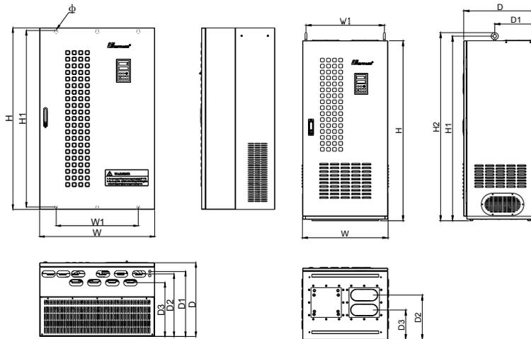
(e): 220KW~280KW 规格尺寸(壁挂)
