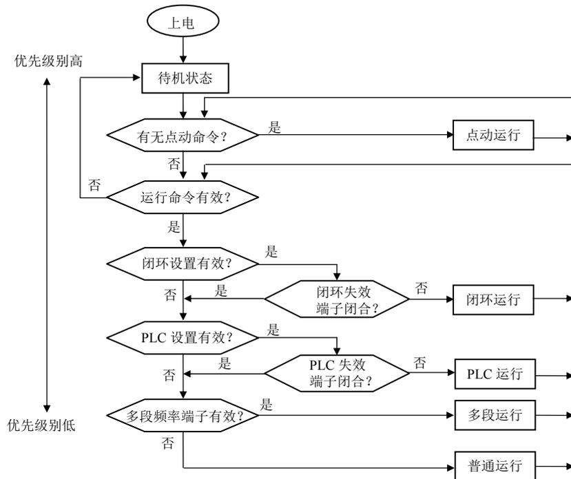
图 4-1 CV3100 变频器运行状态的逻辑关系图
