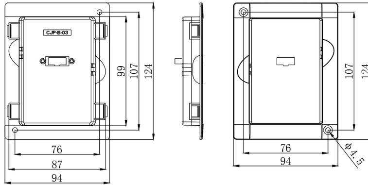
图 2-1 CV3100-LKD 外引托板尺寸 (选配件)
