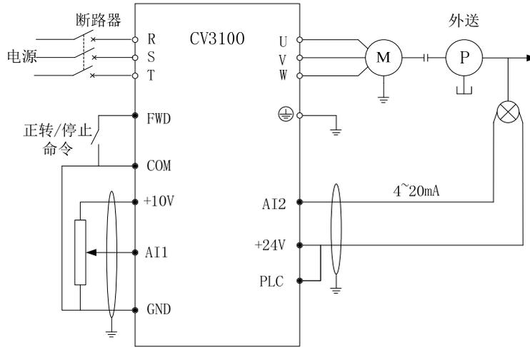
图 6-20 模拟反馈控制系统示意图
