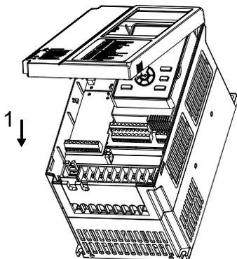
图 3-11 盖板的安装
