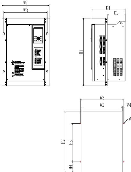
(2) 钣金结构嵌入式安装支架规格尺寸
