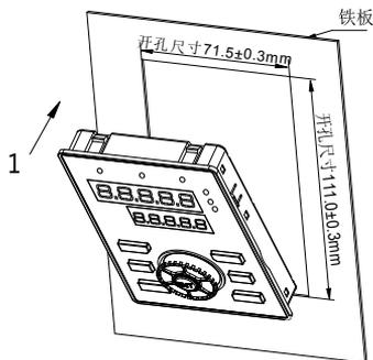
远程键盘安装在铁板上，安装过程如图所示，按图方向 1 压下键盘，听到“咔嚓”一声为止。
