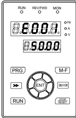
图 4-6 加速中过流故障报警显示
