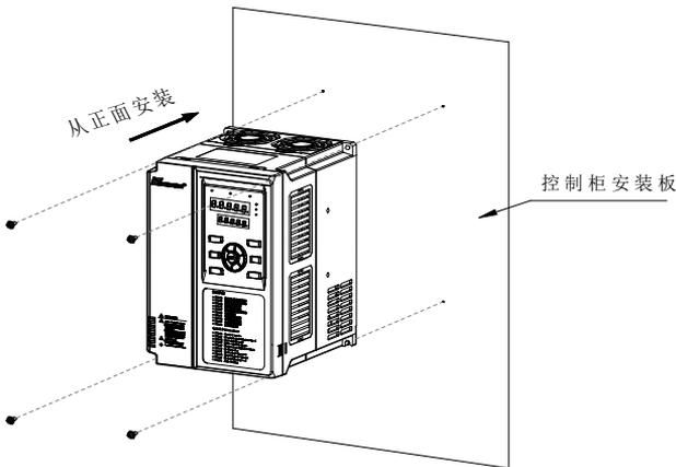
图 3-3 塑胶结构壁挂式安装示意图
