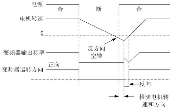
图6-7 转速跟踪再起启动示意图
