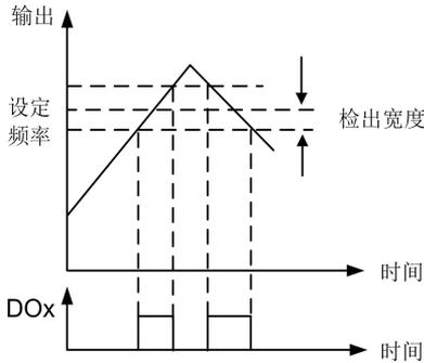
图6-31 频率到达信号输出示意图
