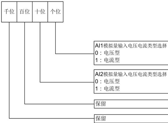
图 6-21 模拟量输入采样设置
