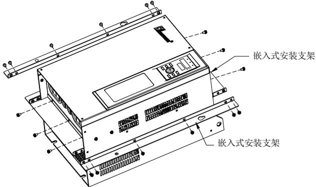
图 3-8 钣金结构安装外挂支架示意图
