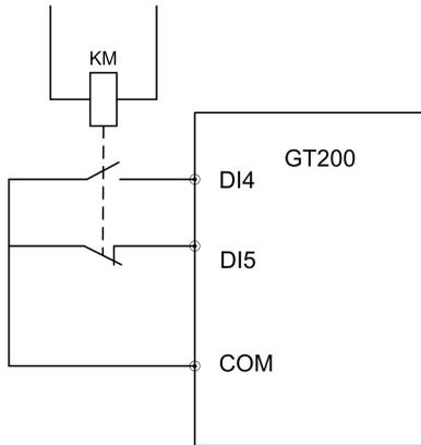
图6-24 外部设备故障常开/常闭输入示意图
