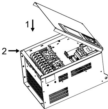
图 3-13 盖板的安装
