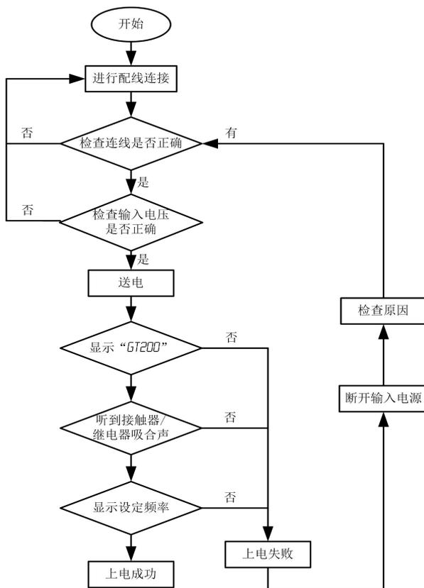
图 4-9 变频器初次上电操作流程
