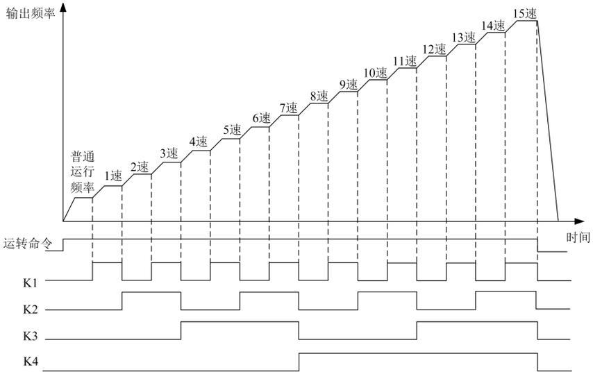
图 6-22 多段速度运行示意图
