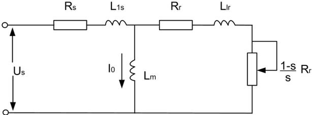
图6-15 异步电机稳态等效电路图
