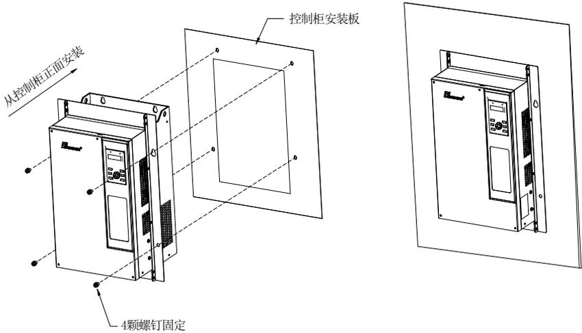
图 3-9 钣金结构嵌入式安装示意图
