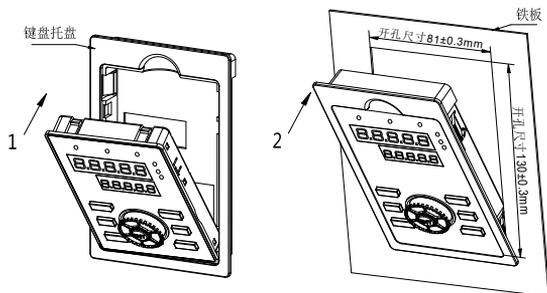
远程键盘安装在选配件键盘托盘上，安装过程如图所示，按图方向 1 把键盘放进键盘托盘内，装好后按照图方向 2 压下整个键盘，听到“咔嚓”一声为止。
