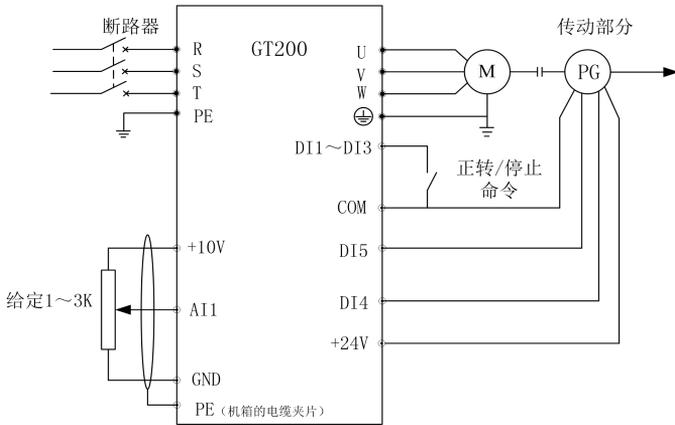
图6-37 PG速度闭环控制系统接线图
