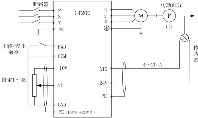
图6-36 内置PI模拟反馈控制系统示意图
