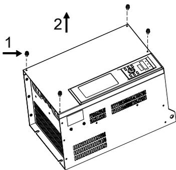
图 3-12 盖板的拆卸
