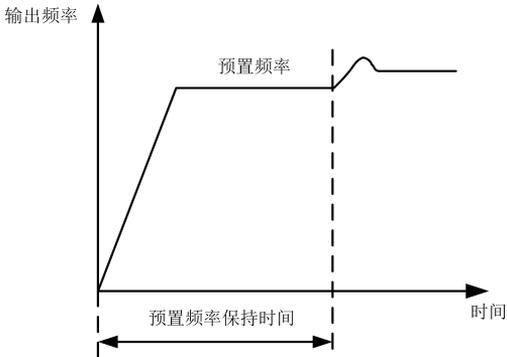
图6-44 闭环预置频率运行示意图
