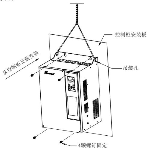
图 3-6 钣金结构壁挂式安装示意图
