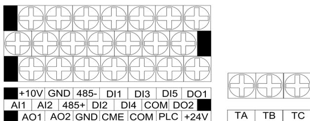
图 3-19 GT200-4T0040G/4T0055P 及以下控制板端子排列顺序图
