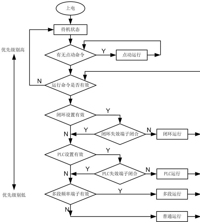
图 4-1 变频器运行状态的衍变逻辑
