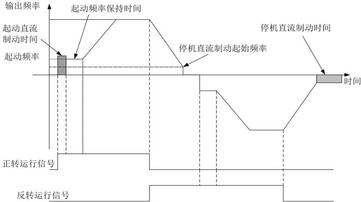
图 6-6 起动方式 1 示意图
