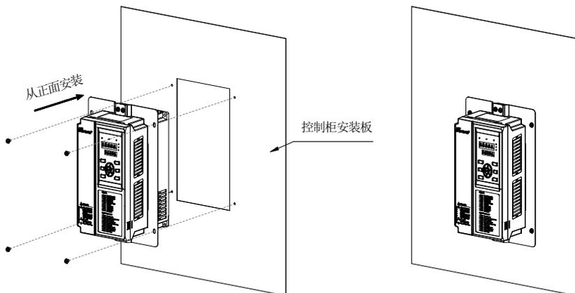
图 3-5 塑胶结构嵌入式安装示意图
