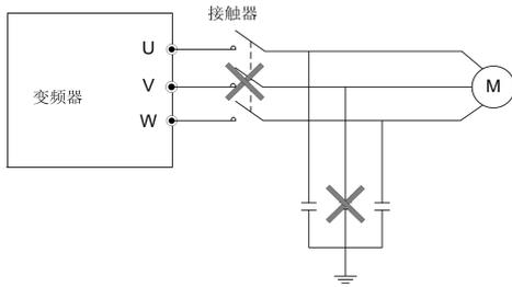
图 1-4 变频器输出端禁止使用电容器
