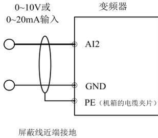
图 3-20 模拟输入端子配线图
