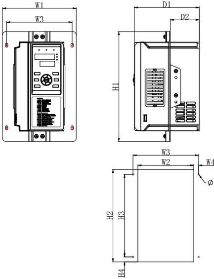
(1) 塑胶结构嵌入式安装支架规格尺寸
