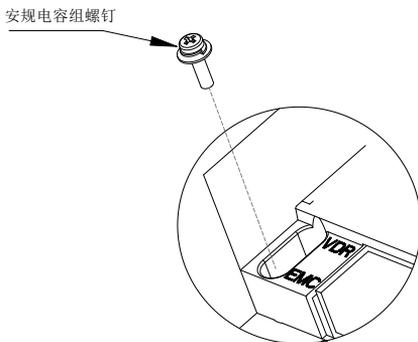
图 3-18 安规电容（EMC）短接螺钉位置示意图
