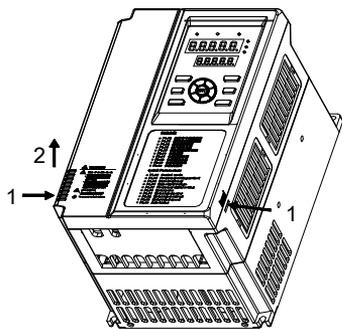
图 3-10 盖板的拆卸
