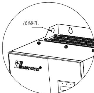
图 3-7 钣金结构吊装示意图
