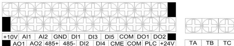
图 3-20 GT200-4T0055G/4T0075P 及以上控制板端子排列顺序图
