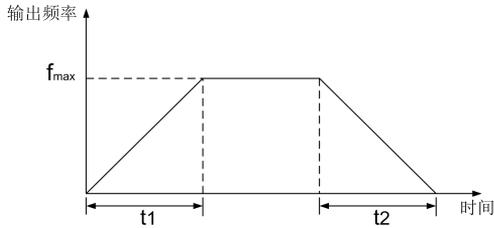
图 6-3 加速时间和减速时间设置说明
