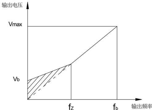
Vb: 手动转矩提升电压      Vmax: 最大输出电压
