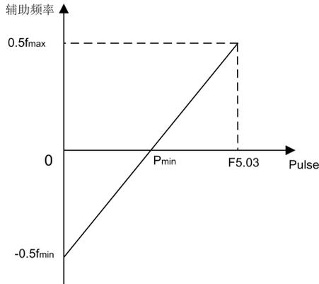
$P_{min} = 1/2 * \text{最大输入脉冲频率 (F5.03)}$
